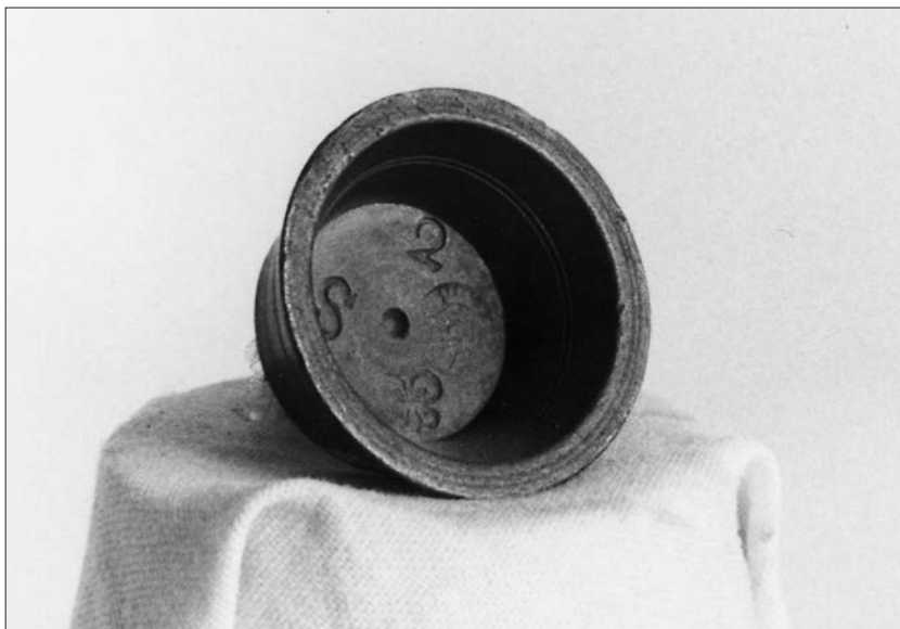
Afb. 8. Messing pijlgewichtje van 1 trooise ons (30,4 gram), afkomstig uit een sluitgewicht. In het gewichtje staan de volgende merken: (1) een franse lelie als teken van het trooise gewichtstelsel, (2) een leeuw met pijlenbundel, zwaard, kroon en de letters I, L en A, vermoedelijk het merk van de ijkmeester-generaal van de Noordelijke Nederlanden: Iacob l'Admiraal, (3) de letter S voor het jaar 1752 en (4) het getal 2 als aanduiding voor het gewicht van 2 lood (=1 trooise ons). Het gewichtje is voor de foto op zijn kant gelegd. Foto: Jaap Buist.
