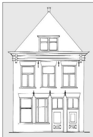
Afb. 19. (rechts) Haddingestraat 15, voorgevel voor de verbouwing van 1950, zoals opgemeten voor een bouw aanvraag in 1946 (bouwdossier Gemeente Groningen). Het rechtervenster op de begane grond is een erkervormig etalageraam. Tekening: Henk Wierts.
