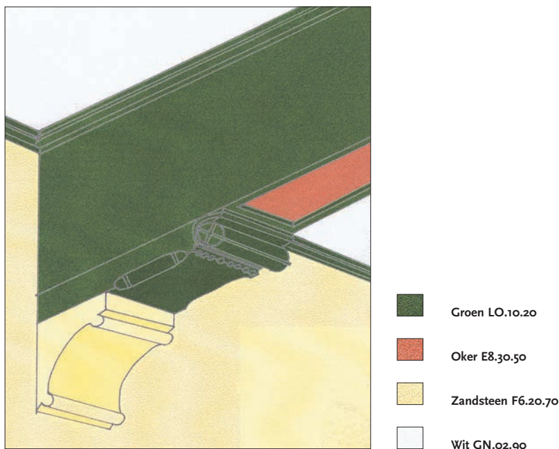
Afb. 14. Resultaat kleuronderzoek plafondbalken in een voormalige laboratoriumruimte. Tekening: K. Verheij.
