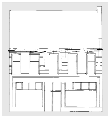
Afb. 13. Gelkingestraat 20, de voorgevel met daarop aangegeven de gevonden bouwsporen. Tekening: Reitse de Vries, collectie Dienst RO/EZ.
