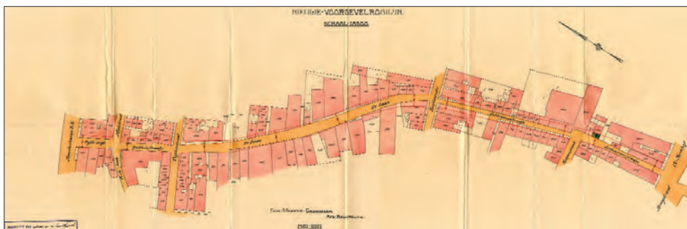
Afb. 2. Nieuwe voorkevelrooilijn zoals vastgesteld in 1921. Het gehele tracé zal acht meter breed moeten worden. Tekening: collectie Dienst RO/EZ.
